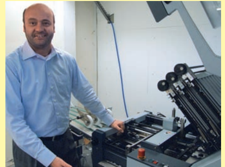
Uwe-Michael Thal am Horizon Crossfolder AFC 566 FKT. Hier werden die gedruckten Bogen für Directmailings gefalzt oder zu Selfmailern verarbeitet.
