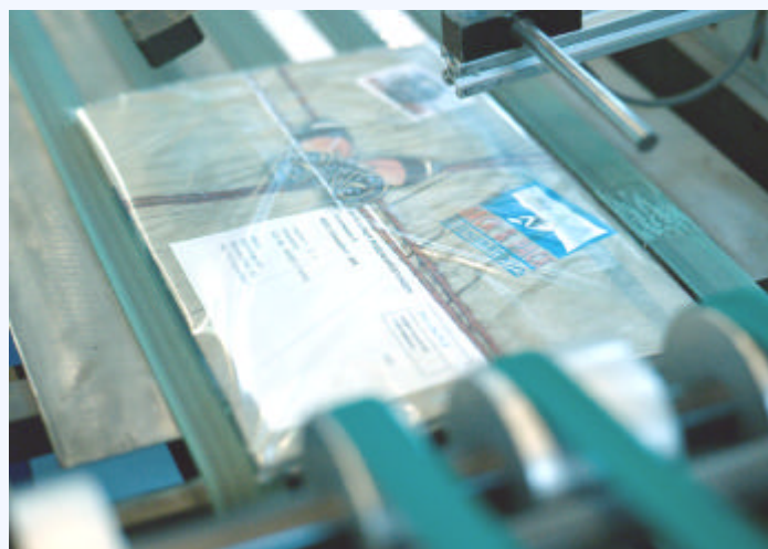
Das Buhrs Polywrap-Folienverpackungssystem ermöglicht SPT die Verarbeitung von 12.000 Katalogen und Zeitschriften pro Stunde
