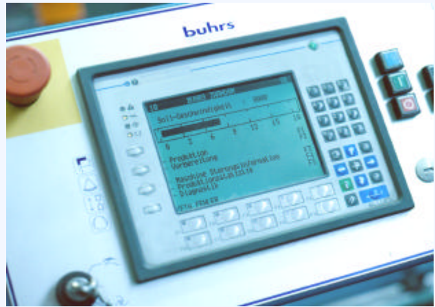
Die Buhrs 3000 wird komplett über einen Touchscreen eingerichtet
